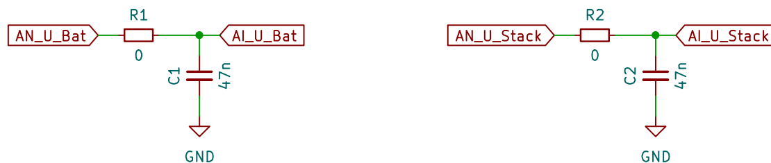
Abb. 5.5: RC-Filterschaltung vor Analogeingängen
